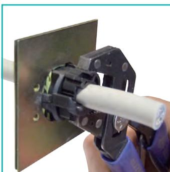
**Esempio di come fissare il cavo con l'utilizzo di un utensile.**
