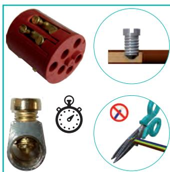
**Riduzione dei tempi di installazione.** Cablaggio veloce a perforazione di isolante: inserire il cavo senza spelare la guaina e avvitare la vite di colore oro.
